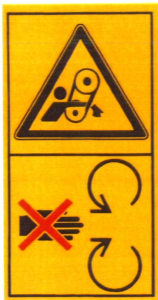
Riemenschutzschirme dürfen nur in dem Fall entfernt werden, dass Service ausgeführt werden soll. Sie müssen vor Inbetriebsetzung der Maschine wieder montiert werden.
