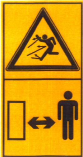
Sicherheitsabstand 20 Meter. Es ist Aufgabe des Operateurs zuzusichern, dass die Sicherheitszone eingehalten wird.
