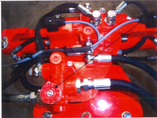
Mit diesem Drehknopf wird die Schwenkgeschwindigkeit eingestellt.
